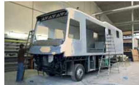
... mit selbst gefertigten GfK-Aufbauten...
