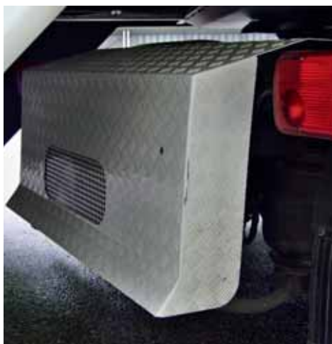
Die Zugmaschine trägt ein eigens gefertigtes Abschlussblech am Heck.
