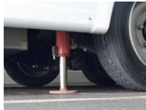
... Hydraulikstützen, die den Auflieger am Standplatz in der Waagrechten halten.
